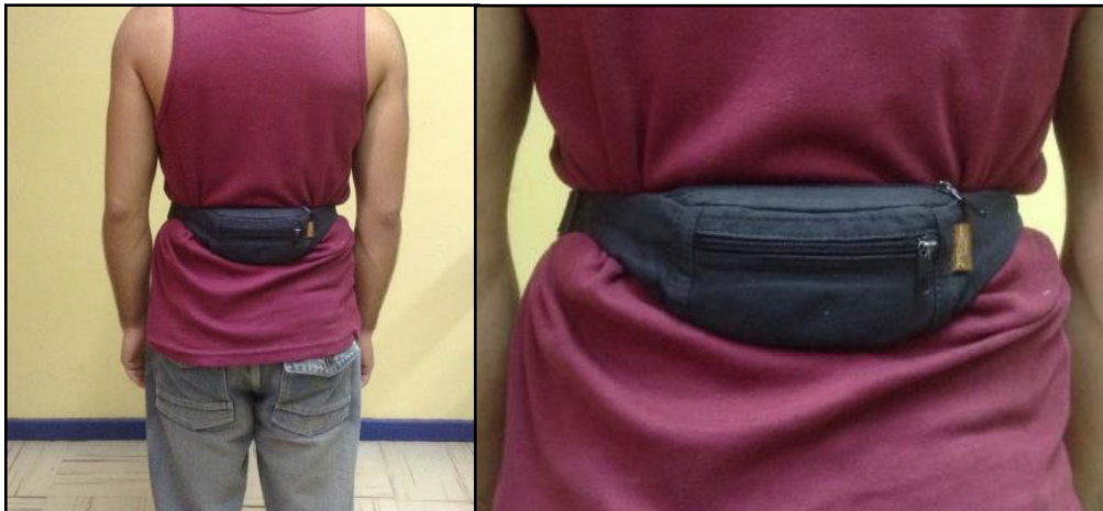
Acelerómetro dentro del estuche posicionado a nivel de L5 para la toma de datos
